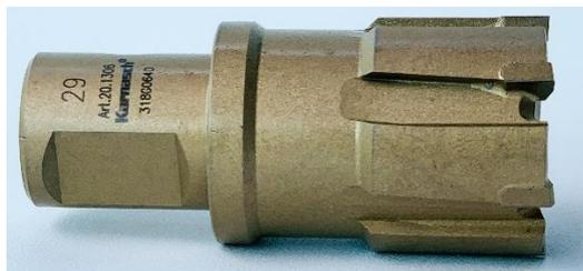
Broca (drill bit) anular oca, ponta metal Sandvik, para mais de 100 furos. *Utilizar o pino HFBOCPIN para resfriamento com líquido de corte.*
