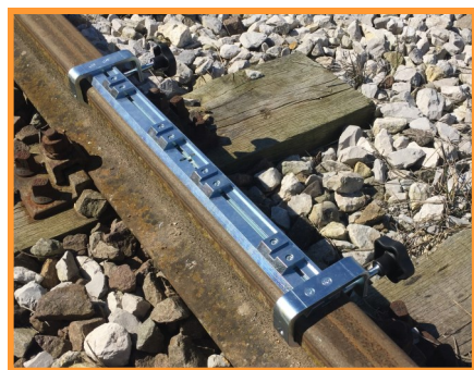
Gabarito (Localizador de furo), para juntas de 4 ou 6 furos, ajustável, que pode ser usado em qualquer tipo de trilho
