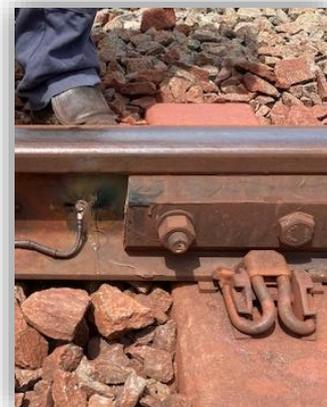
**Código # 5052K** – Conector de trilho modelo T, tipo L, desconectável M6 x 32mm. São 100 conexões por embalagem contendo 100 conectores com porca auto-travante, 100 pinos de brasagem 8mm standard e 100 coroas protetoras 8mm.
