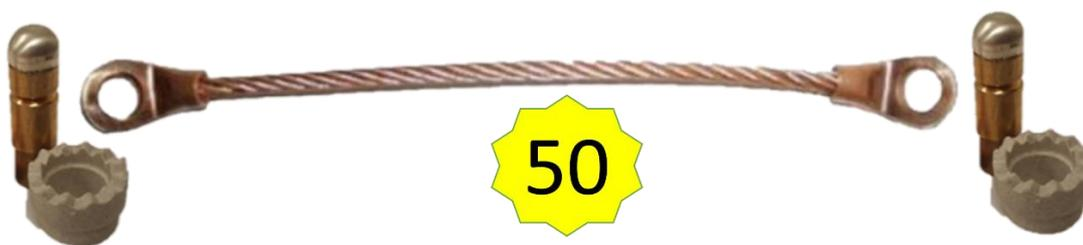
**Código # 3070K** – Rail Bond de boleto em cordoalha de aço recozido e galvanizado 25mm<sup>2</sup> e 145mm de comprimento. São 50 conexões por embalagem contendo 50 rail bonds, 100 pinos de brasagem 8mm standard e 100 coroas protetoras 8mm.
