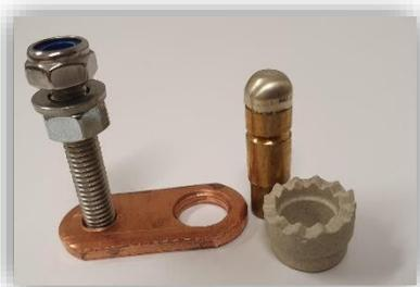
**Código # 5007701K** – Conector de trilho modelo T, tipo C, desconectável M12 x 35mm. São 50 conexões por embalagem contendo 50 conectores com porca auto-travante, 100 pinos de brasagem 8mm standard e 100 coroas protetoras 8mm. Estes são utilizados em vias eletrificadas, feitos para suportar as correntes de tração elétrica que percorrem nos trilhos.
