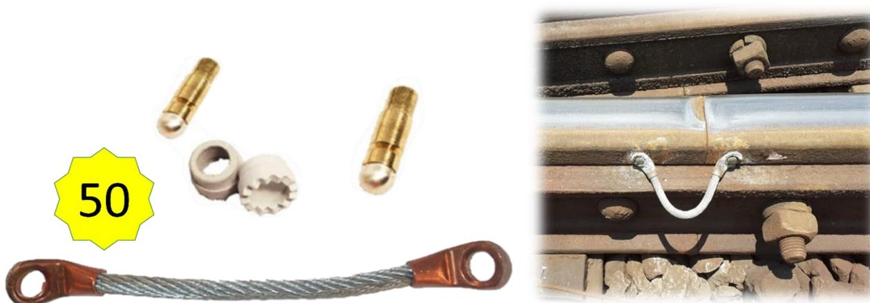
**Código # 304891K** – Rail Bond de boleto em cordoalha de aço recozido e cobreado 70mm<sup>2</sup> e 210mm de comprimento, safecable 60°. São 50 conexões por embalagem contendo 50 rail bonds, 100 pinos de brasagem 9,5mm e 100 coroas protetoras 9,5mm. Estes são utilizados em ferrovias eletrificadas, feitos para suportar as correntes de tração elétrica que percorrem nos trilhos.
